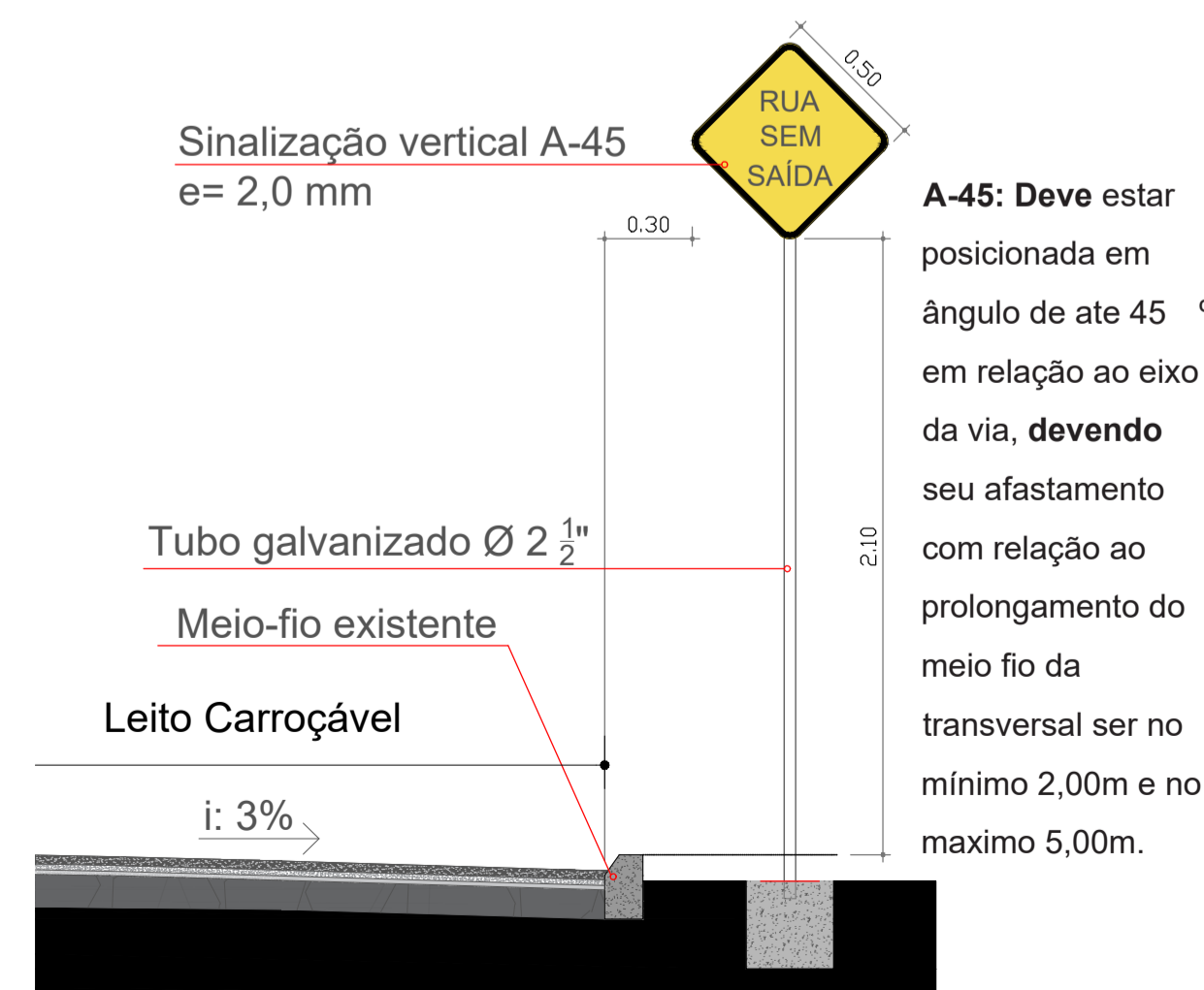
DETALHAMENTO SINALIZAÇÃO VERTICAL Esc: 1/25
