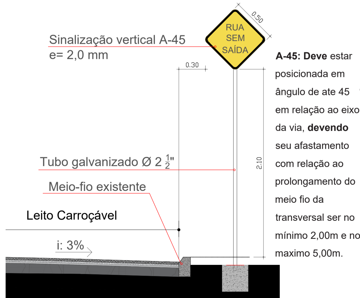
DETALHAMENTO SINALIZAÇÃO VERTICAL Esc: 1/25
