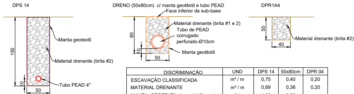
DRENO LONGITUDINAL PROFUNDO ESCALA 1:50
