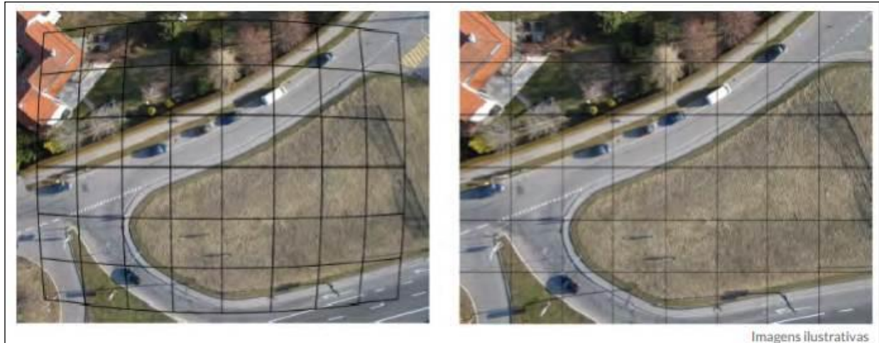
Figura 23: Correção da Projeção Cônica para Ortogonal (Ortorreficação).
