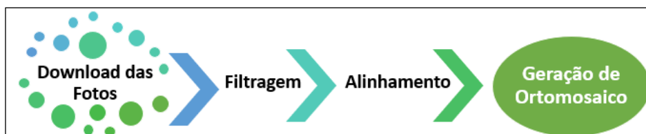
Figura 24: Fluxograma de processamento das imagens.
