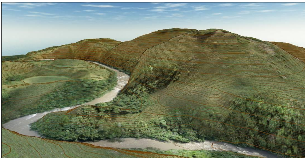
Figura 17: Modelo digital de terreno (MDT) e curvas de nível (Fonte: Real Geosoluções).
