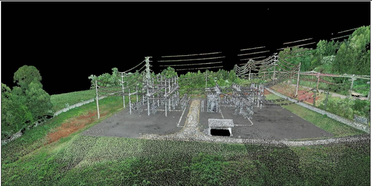
Figura 16 - Modelo de nuvem de pontos produzida pelo sensor Zenmuse L1 (Fonte: Real Geosoluções).
