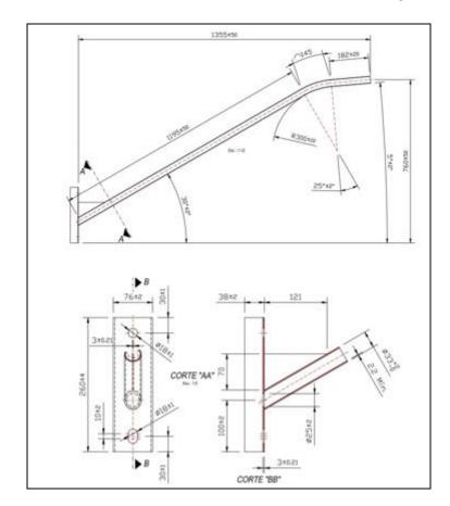
Braço de 1,5 metros – Dimensões em milímetros conforme figura abaixo:
