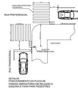
DETALHE POSICIONAMENTO DA PLACA DE PARADA OBRIGATORIA EM RELAÇÃO A ESQUINA E FAIXA PARA PEDESTRES
