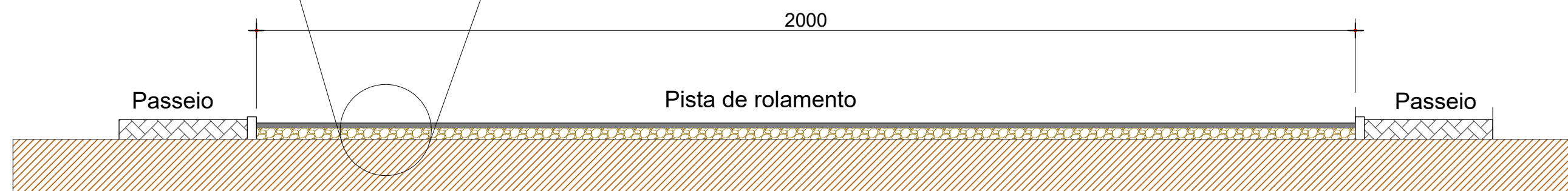
01 PAVIMENTAÇÃO - CORTE TRECHO 01 Escala 1:50
