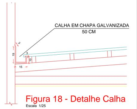
Figura 18 - Detalhe Calha
