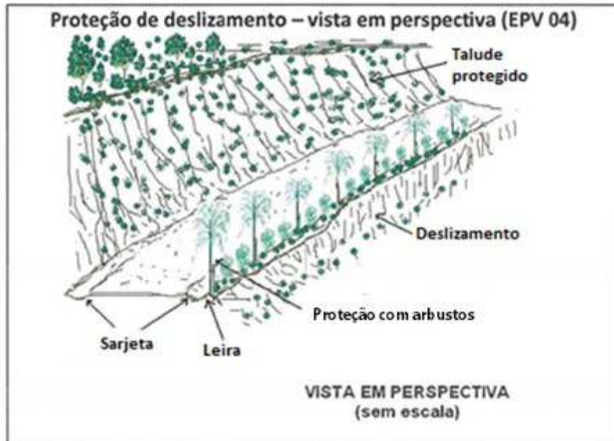
Figura 11 – Proteção de deslizamento – vista em perspectiva (EPV 04)
