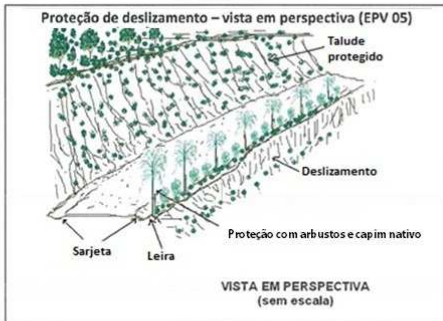
Figura 13 – Proteção de deslizamento – vista em perspectiva (EPV 05)
