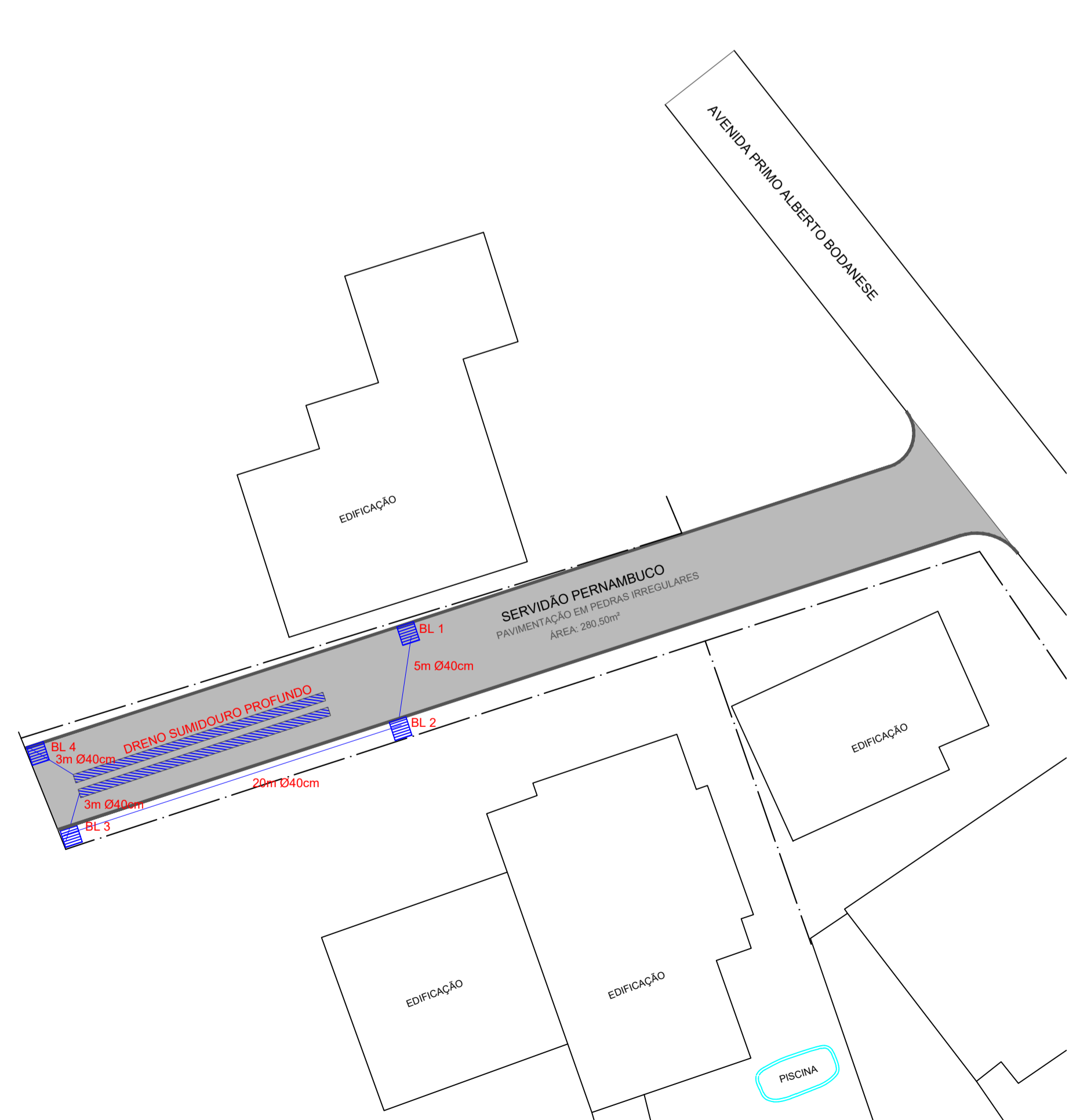
DRENAGEM PLUVIAL ESCALA 1:250
