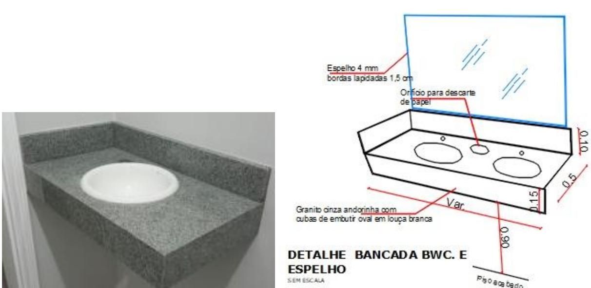
Figura 11. Modelo de bancada com cuba embutida a ser seguido.
