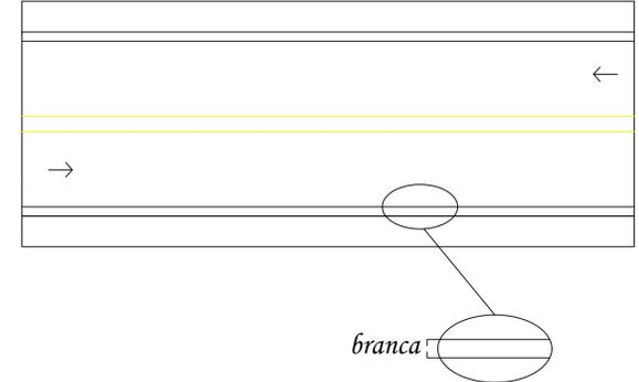
**Definição:** A LBO delimita, através de linha contínua, a parte da pista destinada ao deslocamento dos veículos, estabelecendo seus limites laterais.
