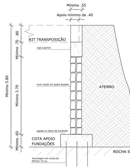
**SEÇÃO DO MURO DE CONTENÇÃO**
