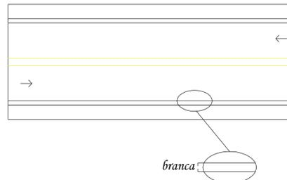
**Definição:** A LBO delimita, através de linha contínua, a parte da pista destinada ao deslocamento dos veículos, estabelecendo seus limites laterais.
